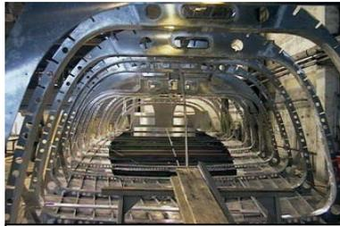
Armature en fer d'un navire
