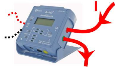
L'ampèremètre doit-être inséré en série dans le circuit.
