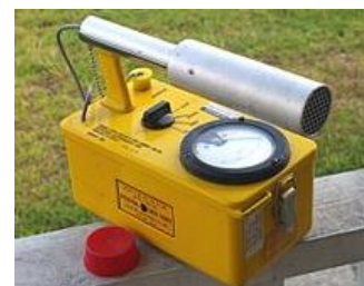
Le compteur Geiger ou radiamètre permet de mesurer l'activité d'une source radioactive en Becquerel
